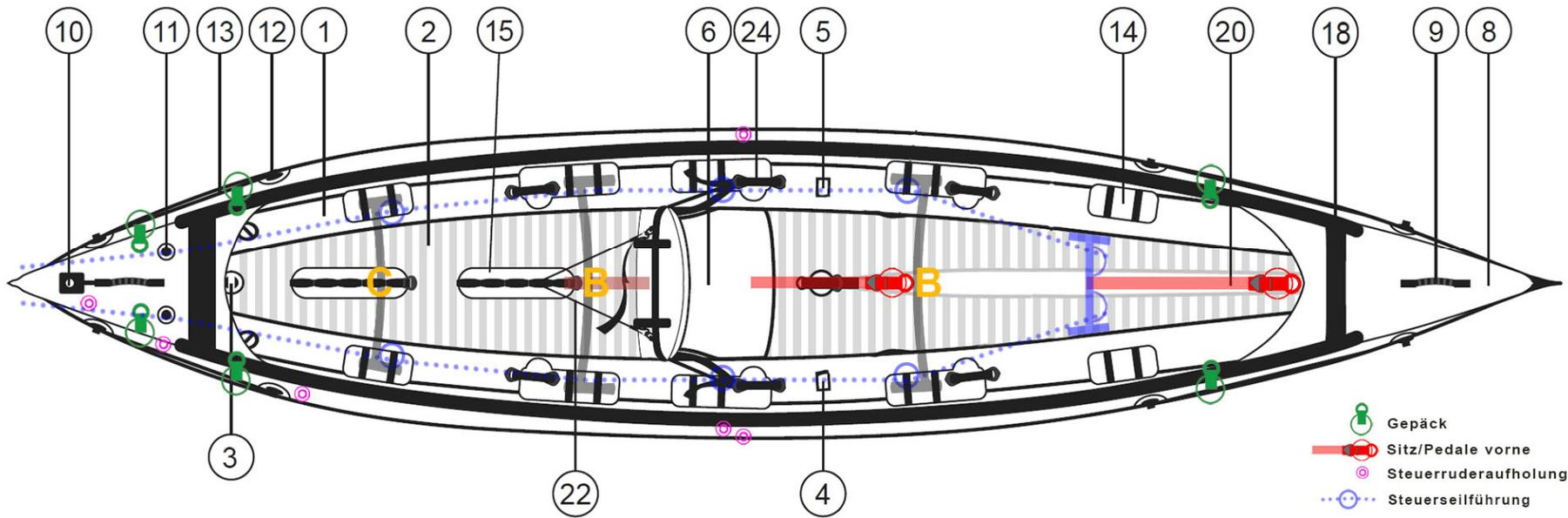
Gumotex Rush 2 – zusätzliche Beschläge – **2er-Konfiguration** – Gepäckbefestigung, Sitzbestigung vorne (und hinten), Steueranlage (Pedale, Seilführung, Ruderaufholung)
